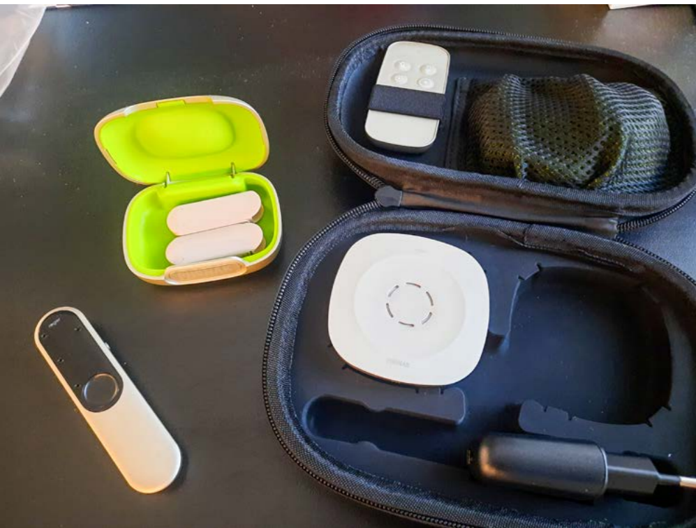
FM-laitteessa on lähetin ja vastaanotin, joka on kuulovammaisella henkilöllä.
