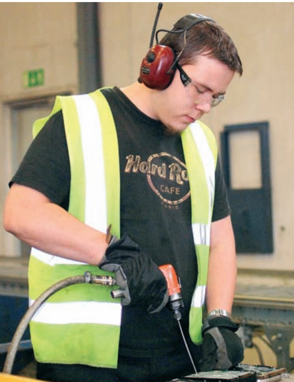
Antti Jääskeläinen irrottaa tietokoneromusta piirilevyt, jotta niiden materiaalit voidaan edelleen työstää kierrätykseen.
